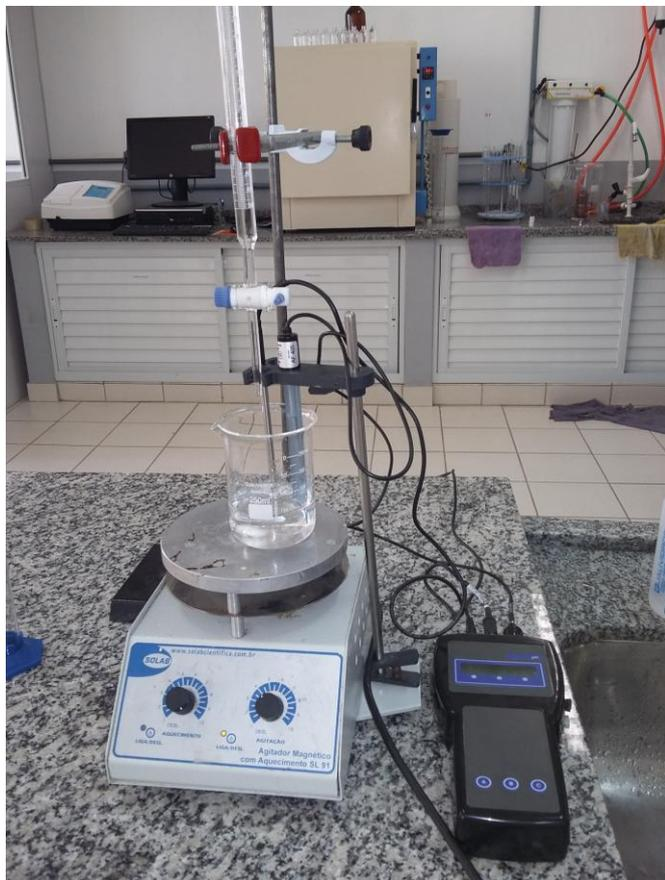
Fig 2. Aparato de titulação potenciométrica.
