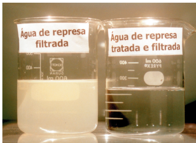
Figura 2: Comparação entre a água bruta apenas filtrada e a água tratada e filtrada.
