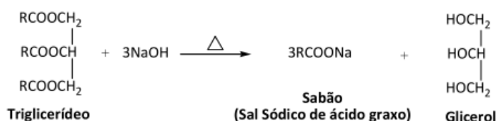
Figura 1. Esquema da reação de saponificação.
