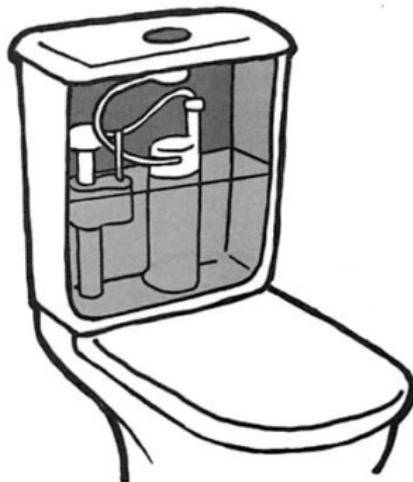
O processo é simples: acabou o serviço, aperte um botão e a água desce da caixa acoplada levando o que tem ali do vaso sanitário para a rede de esgoto.
