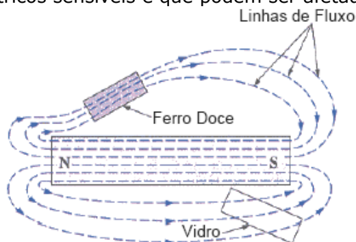
Figura 12: Distribuição nas linhas de campo: material magnético e não magnético.
