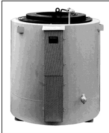
Forno elétrico de cadinho para nitretação em banho de sal.
