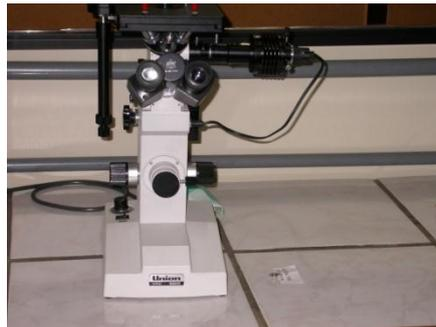
Figura 12-microscópio óptico de reflexão
