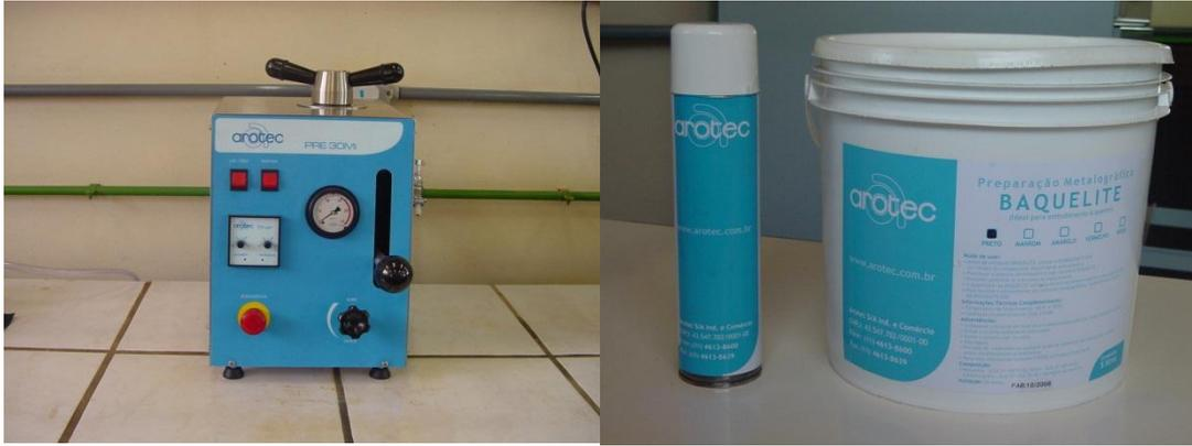
Figura 7-Prensa de embutimento, baquelite e desmoldante.
