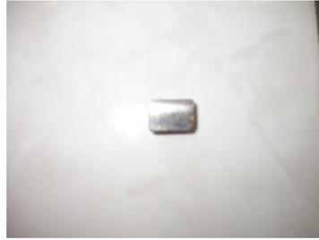
Figura 4-Corpo de prova não embutido
