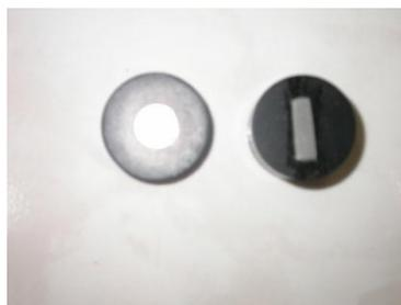
Figura 3 *Corpo de prova embutido a frio à esquerda e a quente à direita*
