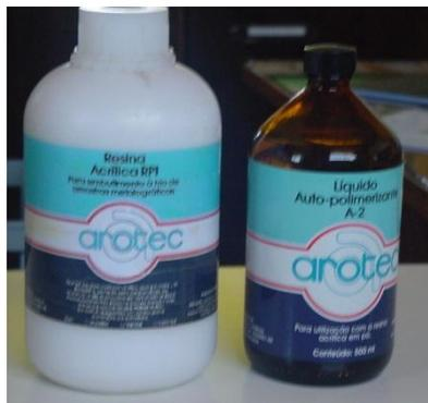
Figura 6-Resina e catalizador utilizados no embutimento a frio
