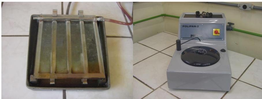
Figura 9-Lixa manual e maquina de lixamento semiautomático
