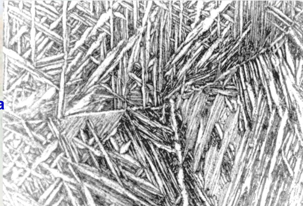
**Liga Ti-6Al-4V: fase de estrutura CCC é estabilizada pela presença do V**
