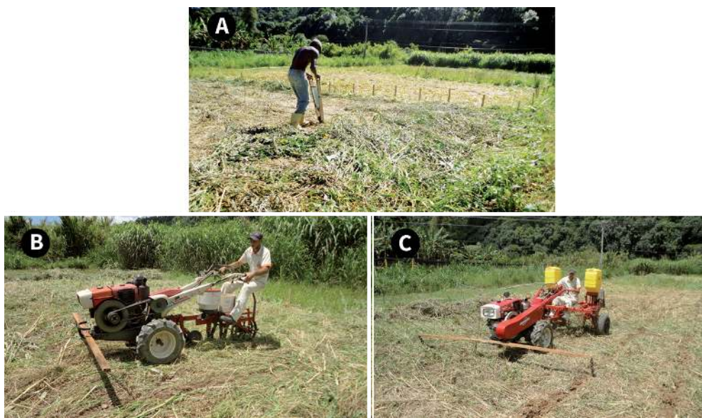
Figura 8. Tipos de plantadeiras para plantio direto: (A) Matraca, (B) Plantadeira 1 linha e (C) Plantadeira 2 linhas. Incaper, Domingos Martins/ES, 2011.
