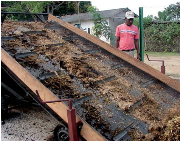
Figura 3. Máquina de revolvimento de composto orgânico sendo testada na UEPA, Incaper de Linhares/ES.
