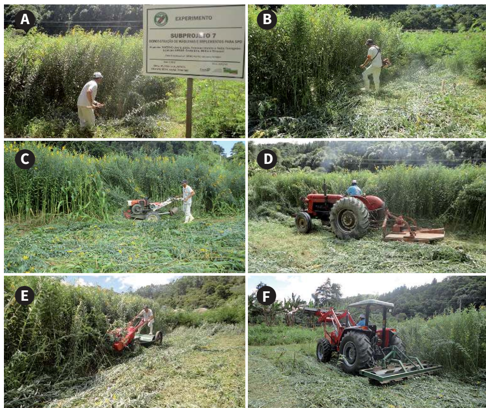
Figura 7. Seis tipos de máquinas e implementos para plantio direto: (A) Foice, (B) Roçadeira costal, (C) Roçadeira frontal de microtrator, (D) Roçadeira de arraste a trator, (E) Rolo-faca de microtrator e (F) Rolo-faca de trator. Incaper, Domingos Martins/ES, 2011.
