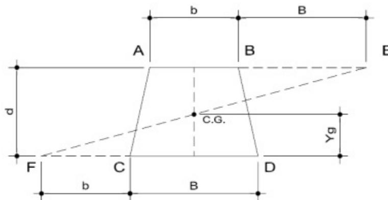
Se tomarmos a figura acima, um trapézio ABCD, a fim de se obter, pelo método mais simples o centro de gravidade da seção, prolonga-se na direção da base menor (AB) o comprimento maior (CD) até E, e na direção da base maior (CB) o comprimento menor (AB) até F. Unindo-se EF, esta intercepta a linha mediana traçada entre AB e CD exatamente no ponto do C.G. (Centro de Gravidade). A medida  $y_g$ , equivale à formulação matemática:
