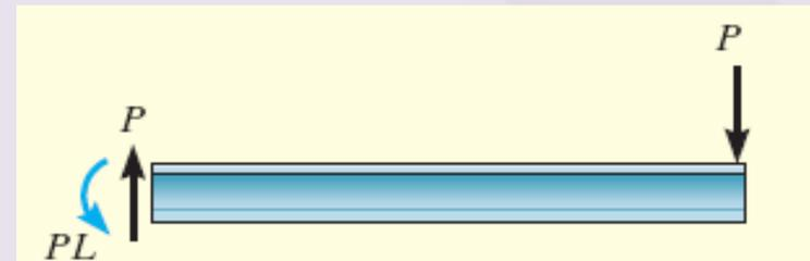
Visto que  $w = 0$ , a *inclinação* do diagrama de força cortante será zero, portanto:
