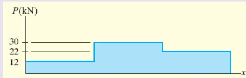
Por inspeção, a maior carga é na região  $BC$ , onde  $P_{BC} = 30 \text{ kN}$ .
