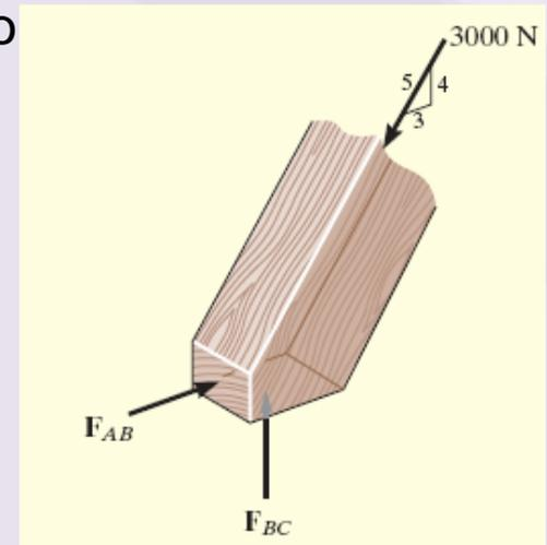
A força de cisalhamento agindo no plano horizontal seccionado *EDB* é
