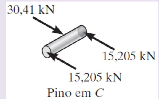
O pino está sujeito a cisalhamento duplo, uma força de cisalhamento de 15,205 kN age sobre sua área da seção transversal *entre* o braço e cada orelha de apoio do pino.
