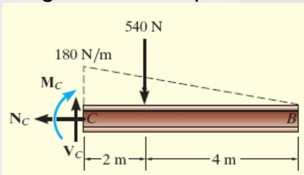
A intensidade da carga distribuída em C é determinada por proporção,
