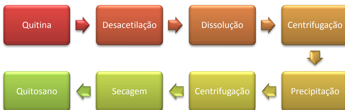
Figura 1.10: Fluxograma simplificado relativo à produção do quitosano (Adaptado de: Moura et al. , 2006).
