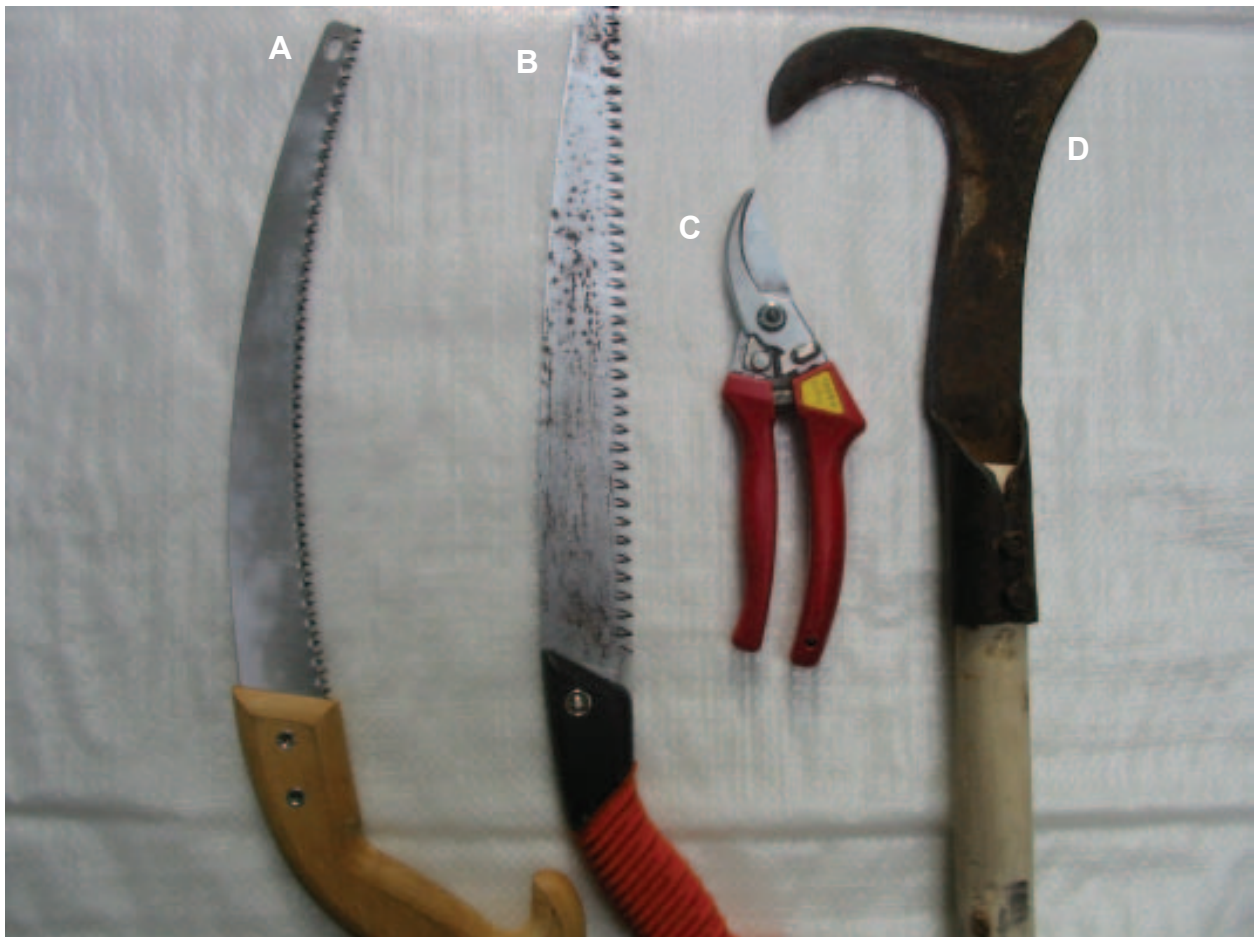
Ferramentas para desrama: (A) serrote com lâmina de “dentes travados”, indicado para pinus; deve estar bem travado e afiado; (B) serrote com lâmina de “dentes de tubarão” indicado para eucalipto; (C) tesoura, indicada para eucalipto nas duas primeiras desramas; (D) foice de desrama, indicada para corte dos ramos finos em eucalipto
