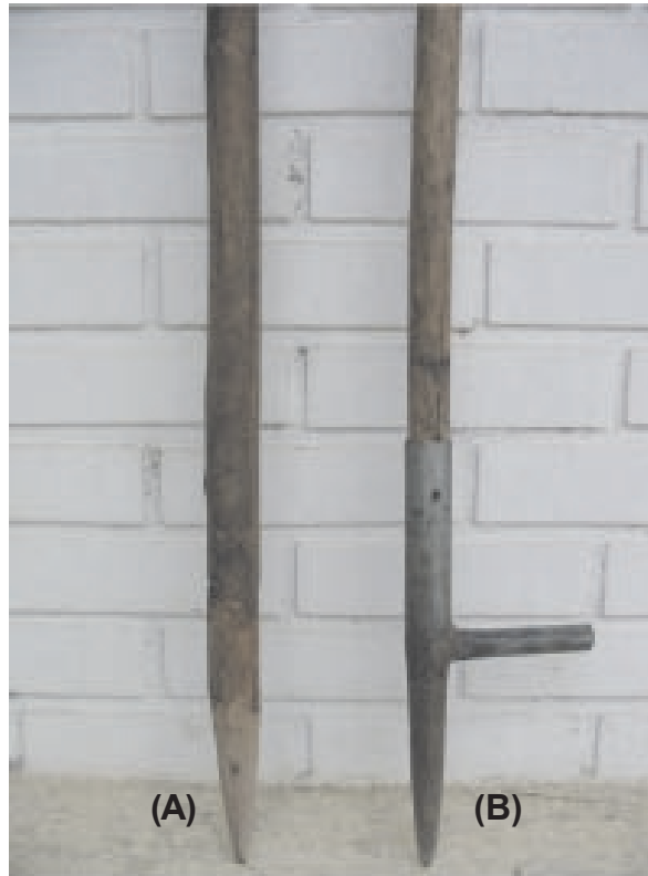
Chucos para plantio de mudas em tubetes: (A) de madeira; (B) de madeira com ponta metálica
