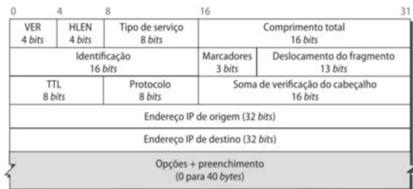
Figura 3 - Cabeçalho do protocolo IPv4
