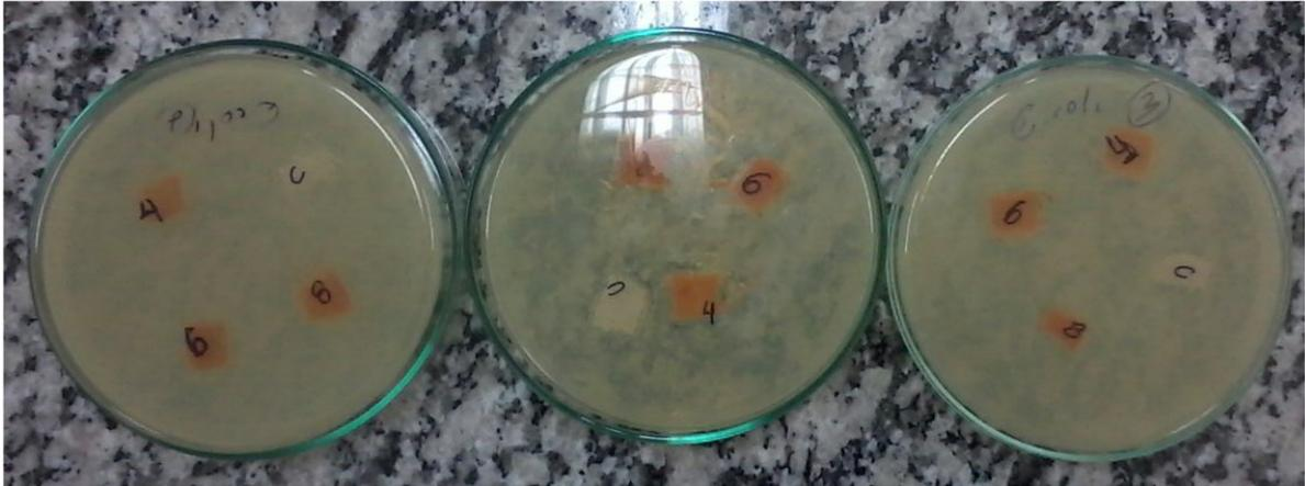
Figura 1. Teste de inibição bacteriana utilizando diferentes massas de urucum.
