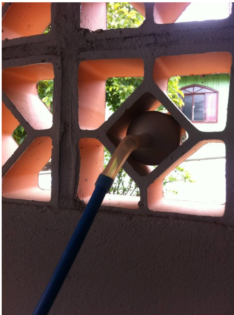
Figura 3: Imagem da forma que foi disposta o suporte com filtro para coleta ambiental.
