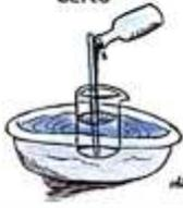
O procedimento correto é operar com os devidos EPs, avental, luvas, protetor facial e em capela. Promover a dissolução do **Ácido** em **Água** com resfriamento simultâneo para facilitar a dissipação de calor.
