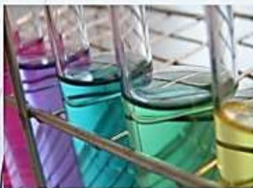
As vidrarias de laboratório em geral são de vidro borossilicato, que é uma mistura sintética de óxido de silício com baixo teor de óxido de sódio e adicionado cerca de 12% de óxido de boro, ( $B_2O_3$ ). Esse vidro adquire boa resistência química, mecânica e térmica, tolerando mudanças bruscas de temperatura de maneira muito superior ao vidro comum.
