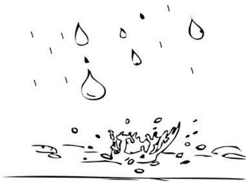
Fig. 19.4 Impacto das gotas de água da chuva em solo desnudo. A grande energia carregada por essas gotas desfaz os agregados do solo com um "salpico", primeiro passo para a erosão hídrica
