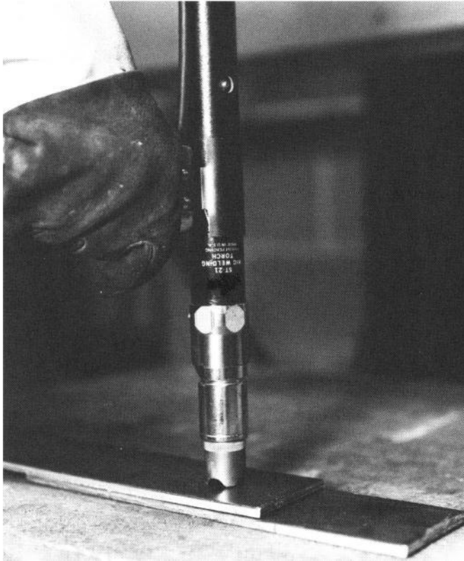
Figura 60 - Técnica de execução de uma solda pontual
