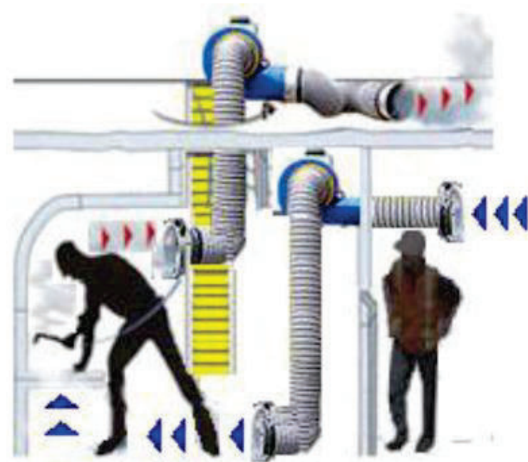
Fig. 54 – Sistemas de ventilação forçada e exaustão para ambientes confinados
