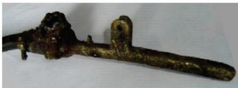
Fig. 40 – Alicata terra danificado
