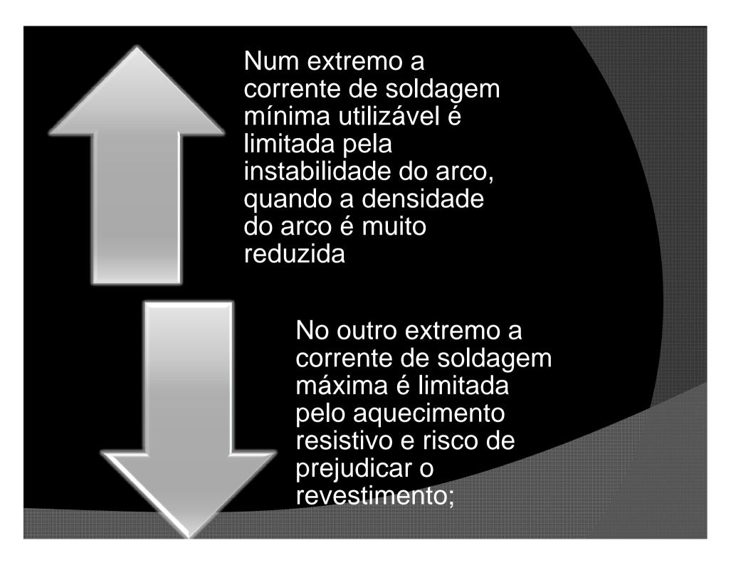
A intensidade de corrente é parâmetro determinante na taxa de deposição, penetração da solda, diluição e largura do reforço do cordão para dadas condições fixas de soldagem
