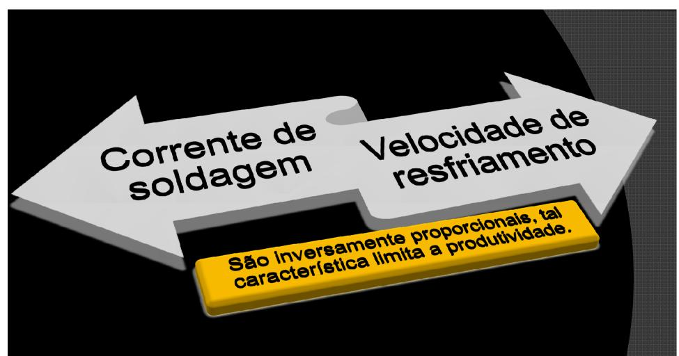
Uma maneira de controlar a velocidade de resfriamento é alterando a velocidade de soldagem. O que também pode limitar o aumento da corrente é o aquecimento excessivo do revestimento, causando assim sua degradação. Tal fator corrobora com a relevância de sempre considerar a recomendação descrita pelo fabricante.
