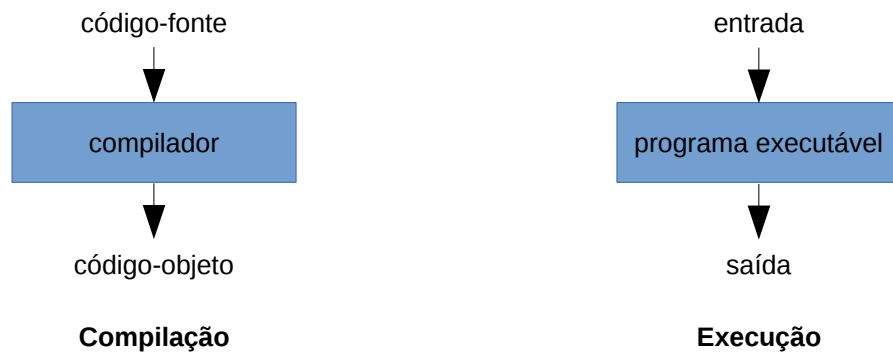
Figura 2 - Compilação e execução ocorrem em momentos distintos
